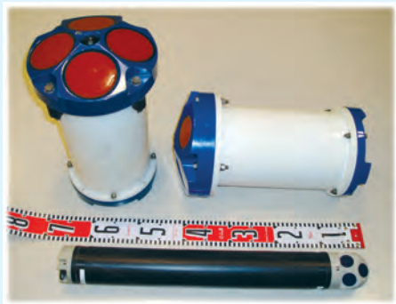
超音波流速計 写真右上: RD Instruments社 WH1200kHz 写真左上: RD Instruments社 WH 300kHz 写真下: Nortek社 Aquadopp Profiler 1MHz
